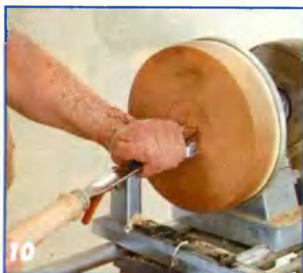
Сначала внутреннюю поверхность чаши грубо обтачивают черновым резцом.
