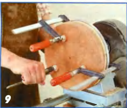
... и осторожно скрепляют струбцинами.
