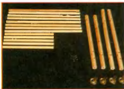
Комплект деталей столика. В торцах ножек видны отверстия под резьбу мебельных роликов.
