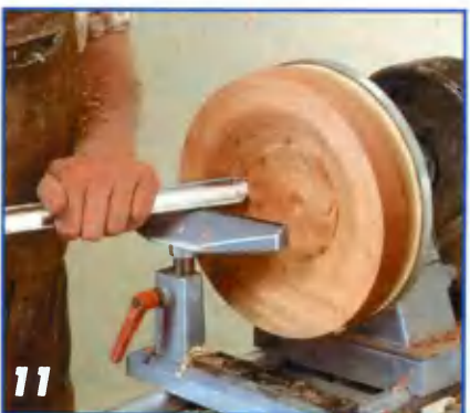
Резец следует перемещать в направлении снаружи внутрь.
