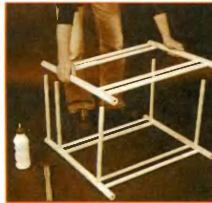
Когда клей затвердеет, боковые рамы соединяют одну с другой поперечными связями.
