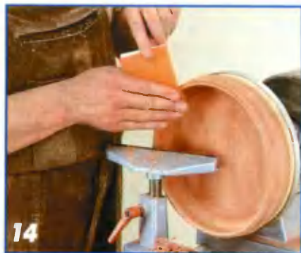
Завершающая фаза работ – чистовое шлифование, производимое шкуркой, по возможности тонкой зернистости. Чистовое шлифование делают при вращении шпинделя станка на предельно малых оборотах.
