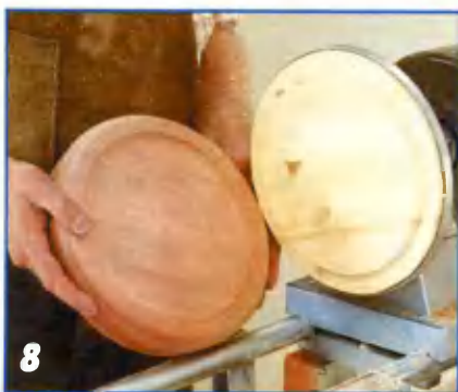
Чашу насаживают на заранее подготовленную деревянную планшайбу ...
