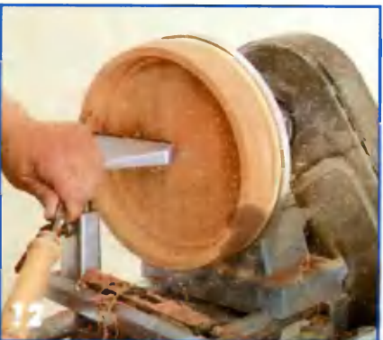
Тонкая обработка малым резцом.
