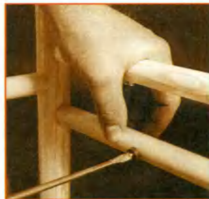
К продольным связям изнутри привинчивают фиксаторы стеклянных полок (уплотнительные шайбы).
