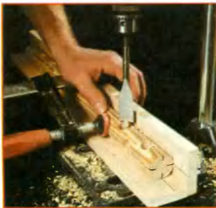
Самодельный шаблон для точного сверления в ножках отверстий под связи.
