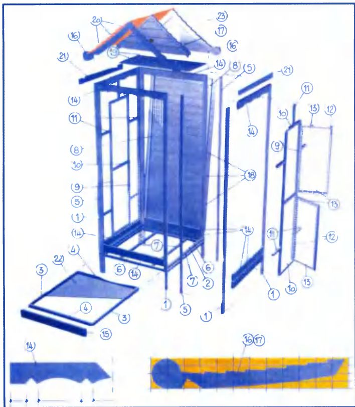
Рис. 1. Конструкция летнего вольера для птиц. Номера позиций соответствуют перечню деталей в таблице 1, в которой приведены размеры. Клетки масштабной сетки на эскизе стропил крыши имеют размеры 50x25 мм
