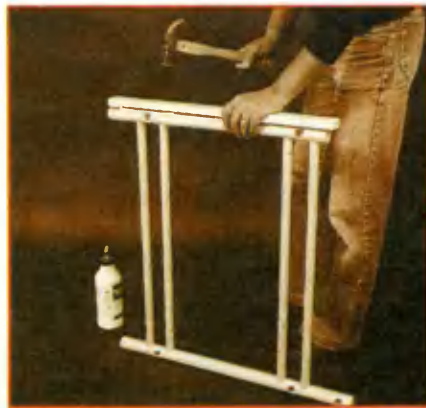
Сборка боковых рам каркаса. Продольные связи вклеивают в отверстия ножек. Чтобы они как можно плотнее входили в отверстия, по ножке надо постучать молотком через деревянную прокладку.
